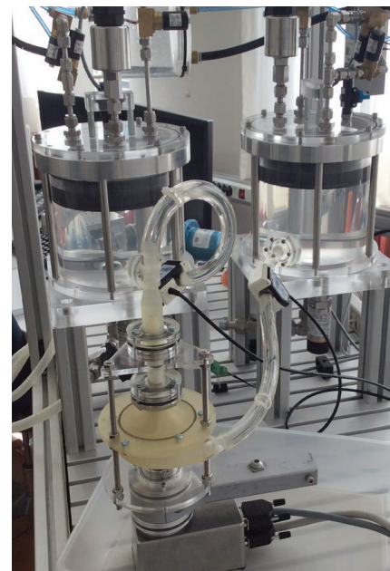
Eine erste ganz in Zürich gebaute Pumpe, die den heutigen Stand der Technik von kommerziellen Systemen integriert und nun den verschiedenen Gruppen als Prototyp und Ausgangslänge zum Testen von Veränderungen zur Verfügung steht, funktioniert seit Mitte 2014 auf dem Prüfstand der Gruppe von Prof. L. Guzzella und Dr. M. Schmid Daners. (Bild: Stefan Boës)
