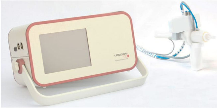
Prototyp eines tragbaren Atemgasdetektors, entwickelt an der ETH Zürich in Kollaboration mit der Firma Loccioni. (Bild: Andreas Güntner)
